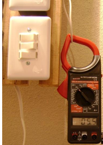
Figura 13 - Alicates amperímetro, marca Instrutherm, modelo VA-750.
