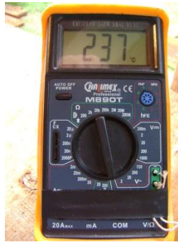
Figura 12–Termômetro marca Kalimex, modelo M890T.
