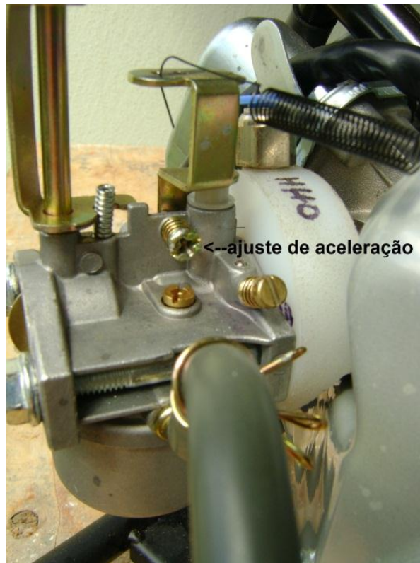
Figura 15 - ajuste manual de aceleração e rotação.
