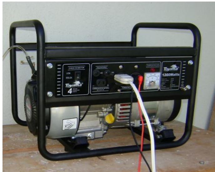
Figura 9 - moto-gerador, marca Toyama, modelo TF1200.
