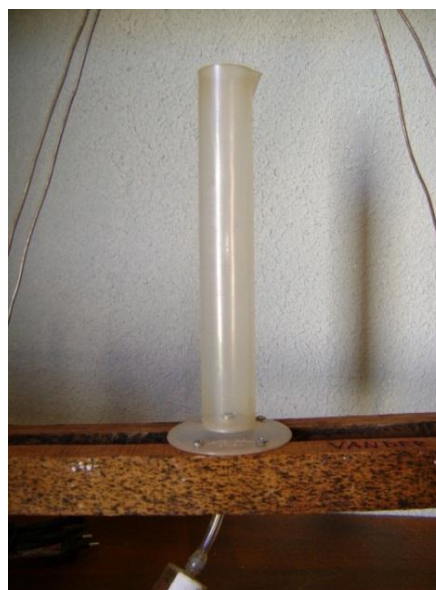
Figura 18 - proveta graduada para medir o consumo de gasolina.
