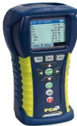
Figura 14 - Analisador de combustão e emissões, marca HOMIS modelo PCA-3.
