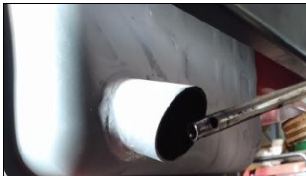
Figura 12. Sonda de amostragem dos gases de exaustão. Fonte: Benhurt Gongora.
