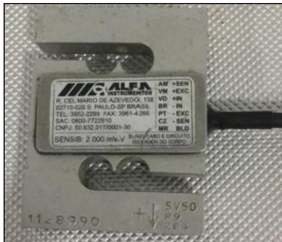
Figura 10. Célula de carga Alfa, modelo SV. Fonte: Alfa Instrumentos (2020).
