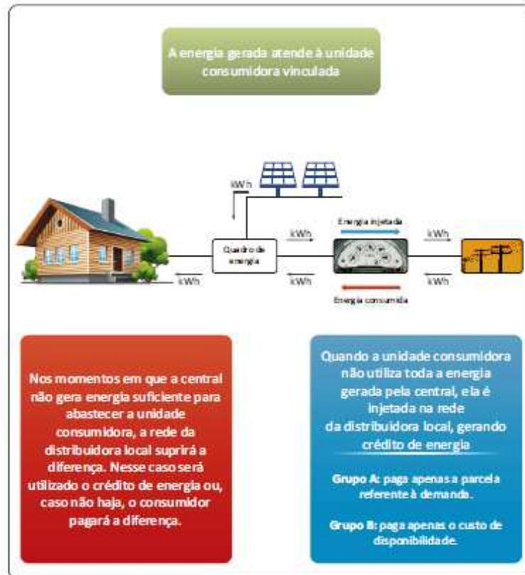
Figura 02: Funcionamento do sistema de compensação de energia elétrica
