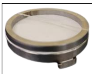
Figura 8: Imagem do aparato para fixação da membrana para o estudo de liberação in vitro . (Fonte: a autora).
