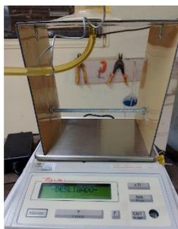
**Figura 21.** Balança Marte As5000, para o peso dos combustíveis
