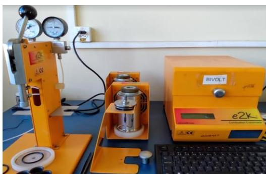
**Figura 16.** Bomba Calorimétrica
