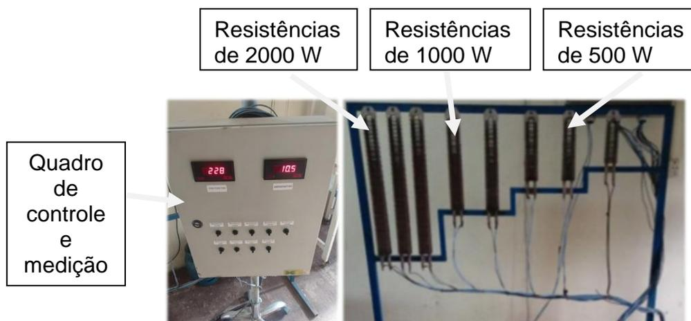
**Figura 17.** Banco de cargas resistivas, sendo à esquerda o quadro com instrumentação para medição das grandezas elétricas e, à direita, as diversas resistências
