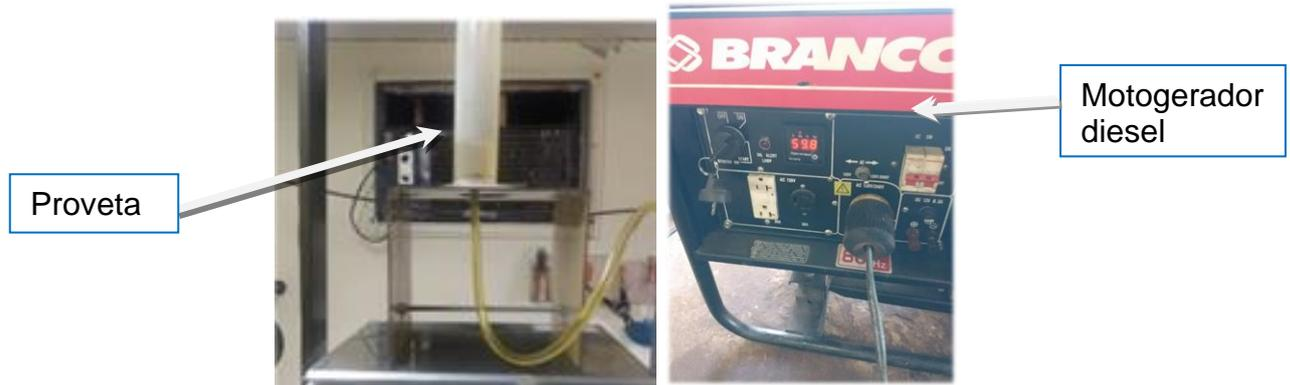
**Figura 22.** Motogerador com proveta e mangueira adaptados para desenvolvimento dos ensaios nos anos de (2023, 2024 e 2025)
