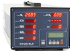
**Figura 25.** Analisador portátil de gases da combustão
