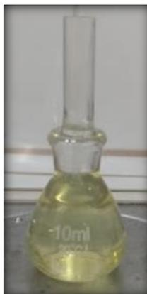
**Figura 24.** Ensaio de densidade com picnômetro
