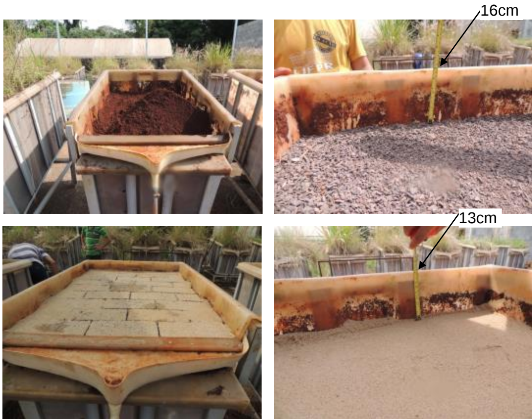
Figura 15. Montagem caixa coletora “C”, passeio público de peças de concreto permeável.
