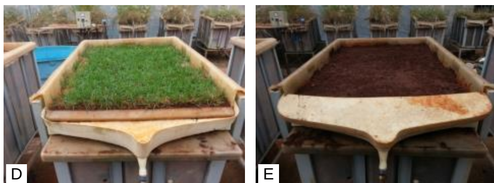
Figura 16. Lisímetro “D” com cobertura em grama e Lisímetro “E” com solo descoberto.
