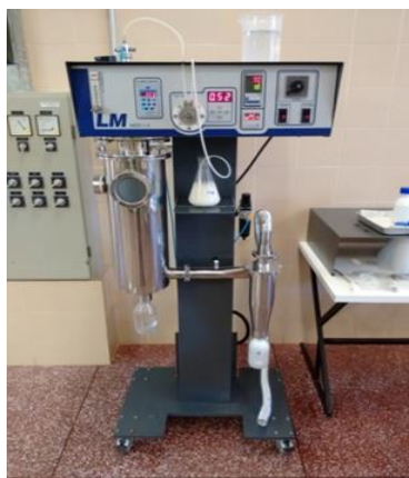
Figura 5 - Spray Dryer utilizado para realização da secagem dos HPPs.
