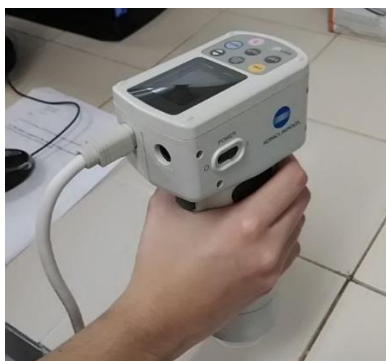
Figura 7 - Colorímetro portátil Konica Minolta Sensing.
