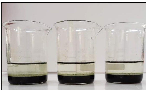
Figura B.2 – Separação de fases na análise de extração e quantificação de lipídeos.
