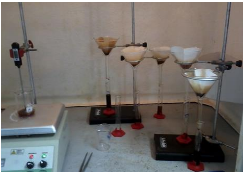
Figura 8: Etapa de aquecimento com agitação e filtração dos óleos – processo de neutralização.
