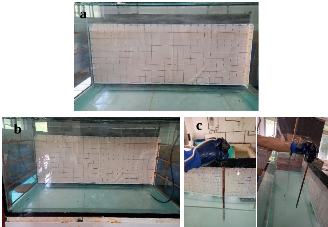
FIGURA 1. a) vista frontal do aquário de testes, b) disposição dos eletrodos condutores pelo aquário de testes, c) leitura das linhas de tensão elétrica no interior do aquário.
