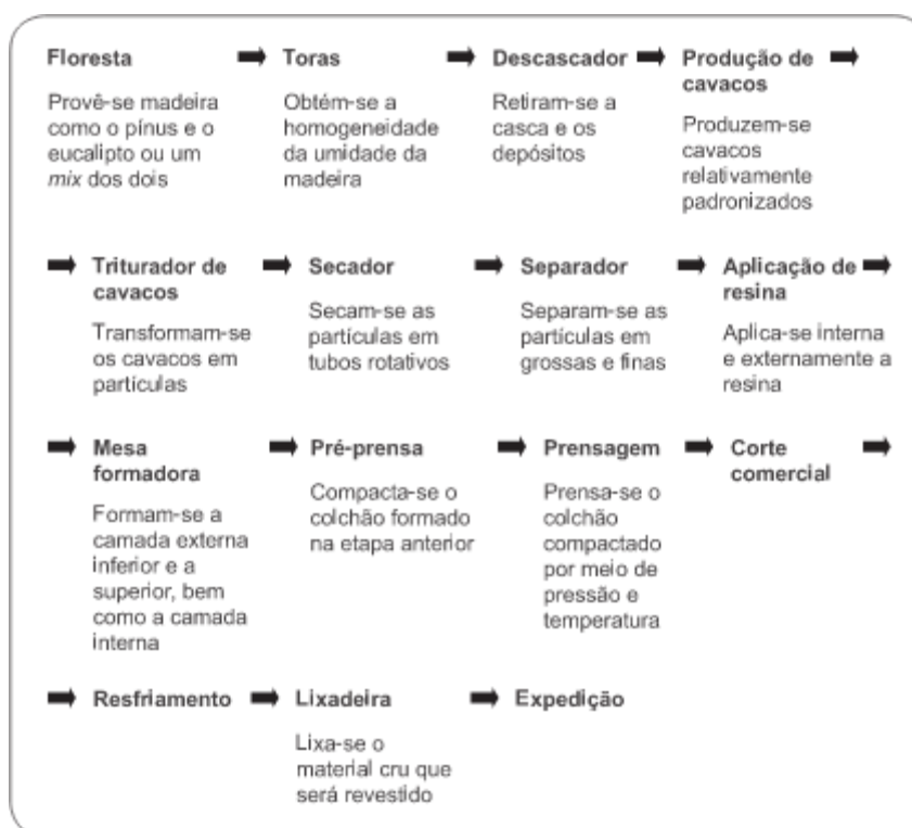
Figura 12 - Processo de produção do MDP
