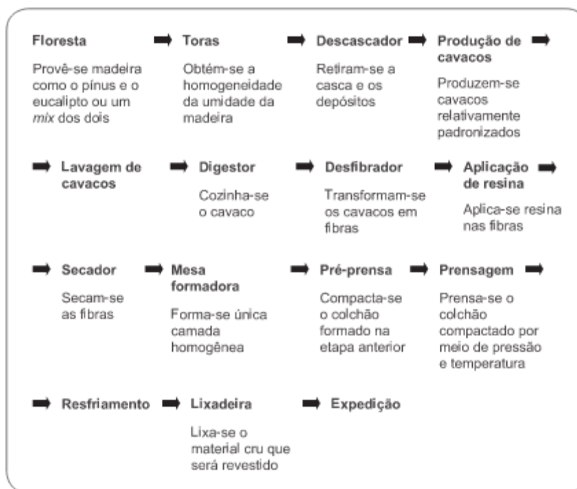
Figura 13 – Processo de Produção do MDF
