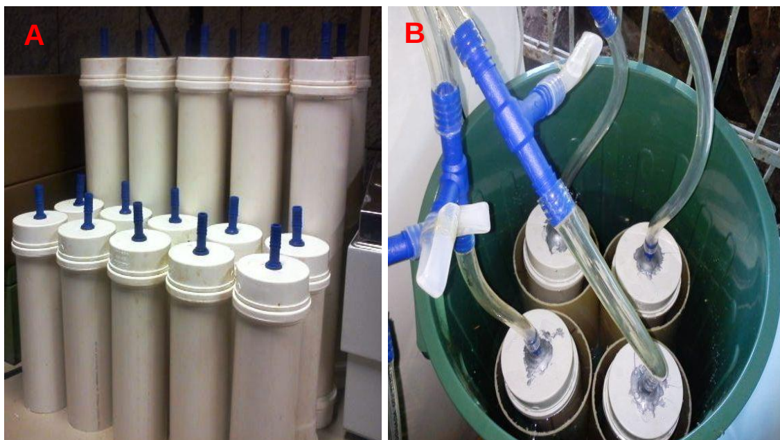
Figura 16. a) Reatores e gasômetros confeccionados; b) Gasômetros visualizados ao exterior das estufas.
