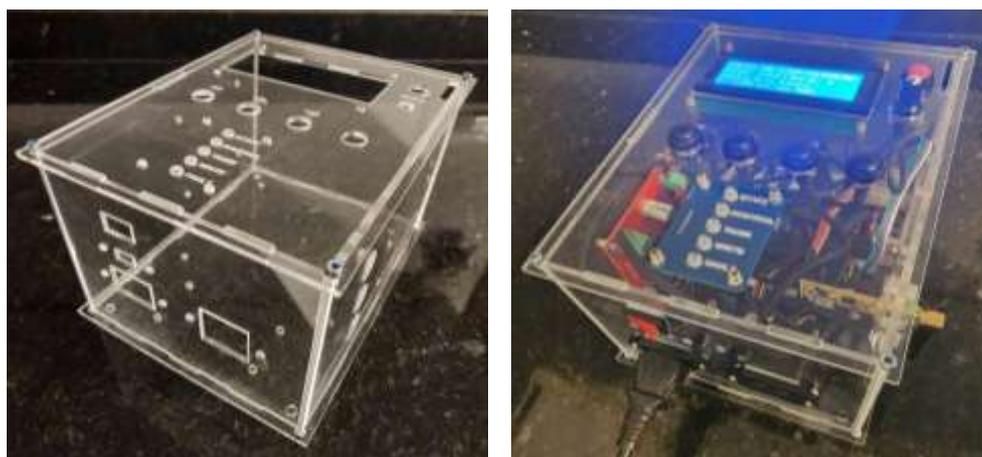
Figura 4.73 - Resultados: Construção da carcaça e montagem da parte física da tecnologia desenvolvida.
