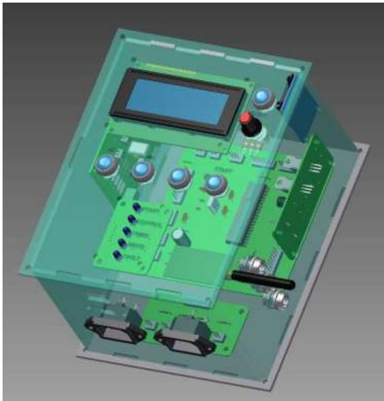
Figura 4.72 Resultado: Desenho da carcaça para a tecnologia SCADA.
