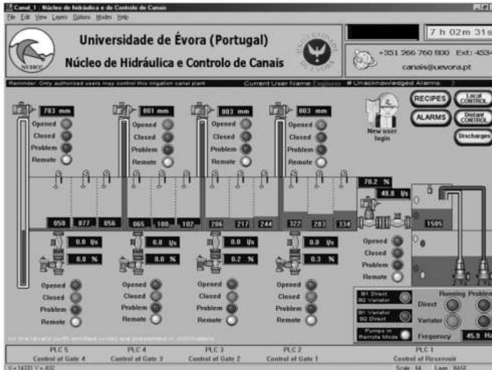
Figura 2.24 – Interface gráfica de um sistema SCADA desenhado em MATLAB para monitorar e controlar canais de irrigação.
