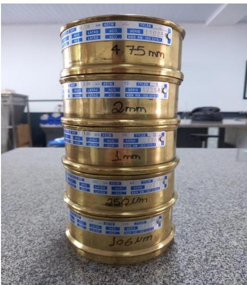
**Figura 8.** Conjunto de peneiras utilizado para análise, compondo-se peneiras da parte superior para inferior: 4,76; 2,00; 1,00 mm; 250 e 206  $\mu\text{m}$ . Foto do autor.
