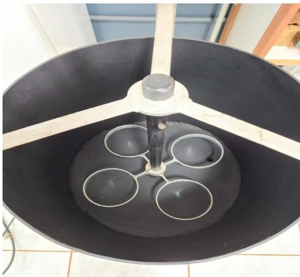
**Figura 7.** Aparelho de oscilação de agregados submersos em água, vista superior dos suportes do conjunto de peneiras. Foto do autor.
