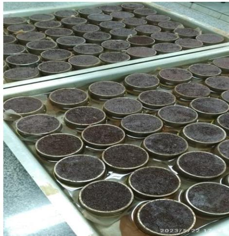
**Figura 2.** Amostras passando pelo processo de saturação a 2/3 de água da altura do anel volumétrico. Foto do autor.
