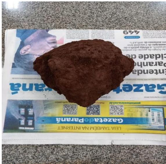
**Figura 4.** Bloco indeformado coletado em camada de 0-10 cm de profundidade do solo, destinado para análise de DMG do solo. Foto do autor.
