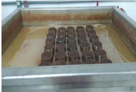
**Figura 3.** Amostras passando pelo processo de extração da água presente nos macroporos em coluna de areia. Foto do autor.
