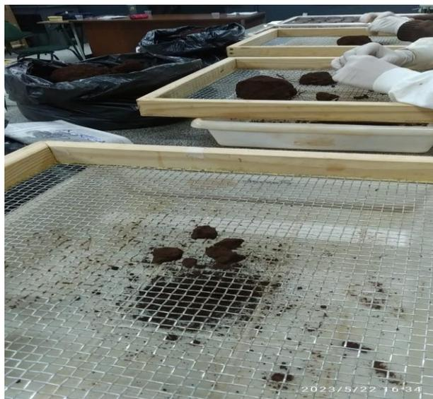
**Figura 5.** Blocos passando pelo processo de separação para formação dos agregados em peneira de diâmetro malha 8 mm. Foto do autor.
