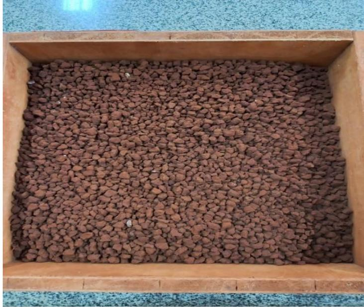
**Figura 6.** Agregados em processo de secagem ao ar, estes passando pela malha 8 mm e retidos em malha 4,76 mm. Foto do autor.
