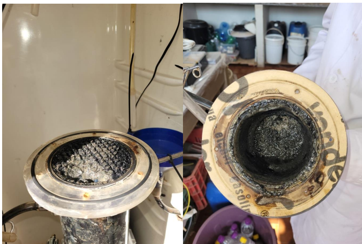
Figura A2 Excesso de crescimento da biomassa, com entupimento do HeadSpace Evento ocorrido entre a segunda e a terceira condição experimental
