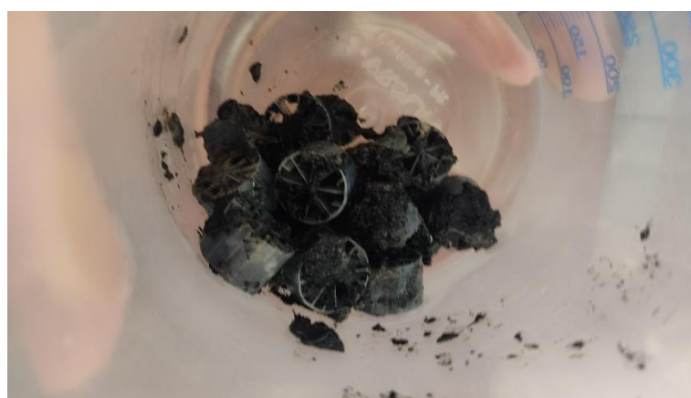
Figura A4 Aderência da biomassa no meio-suporte ao final do experimento
