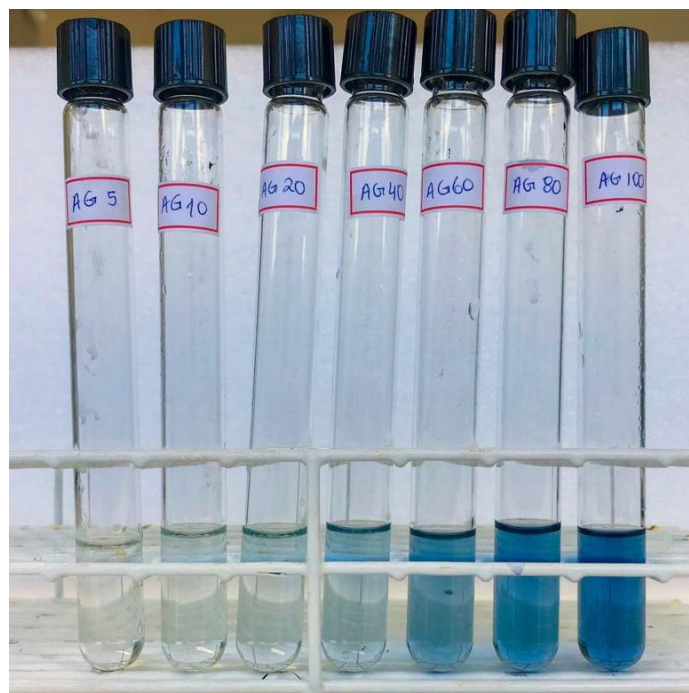
Figura 7: Curva de calibração de Ácido Gálico (Fonte: Autor)
