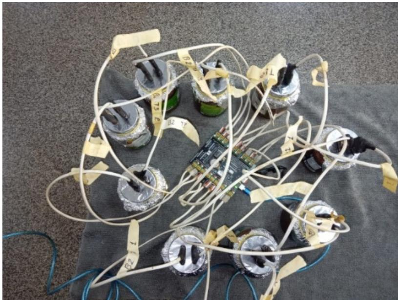
Figura 4 Vista aérea dos sensores nos potes para calibração.
