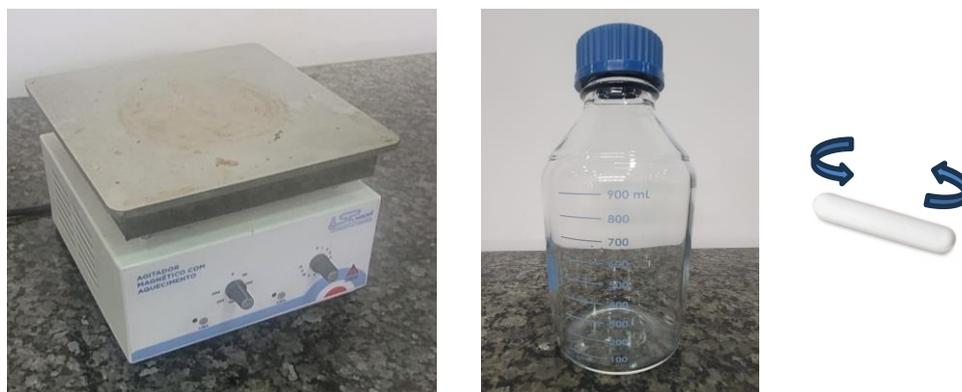
**Figura 13 - Forno com agitador magnético, frasco fechado e barra metálica lisa.**
