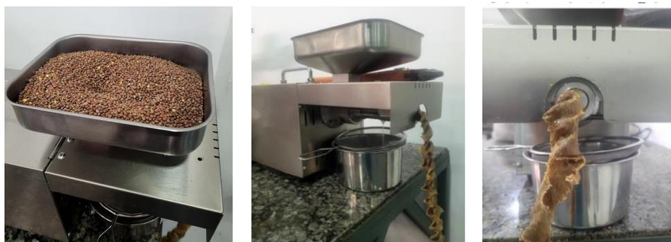
**Figura 9 - Sementes de nabo forrageiro na extrusora, com detalhe do óleo coletado ao centro e a torta, à direita.**
