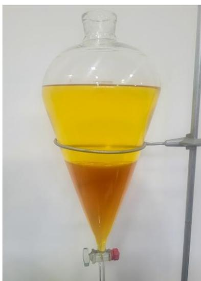
**Figura 16 – Separação de fases entre o biodiesel e o glicerol.**
