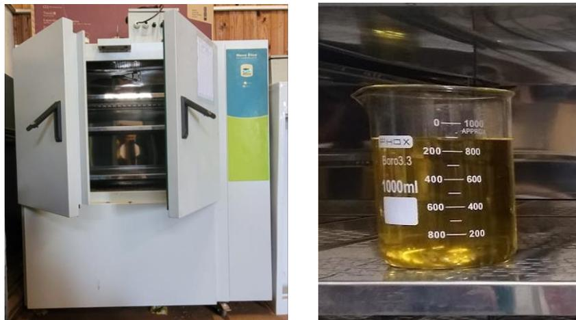
**Figura 18 – Secagem do biodiesel em estufa.**
