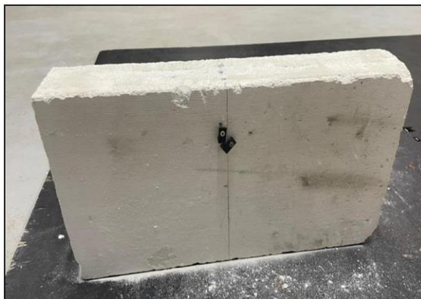
Figura 14 – Amostra de BCCA em processo de fixação dos termopares.
