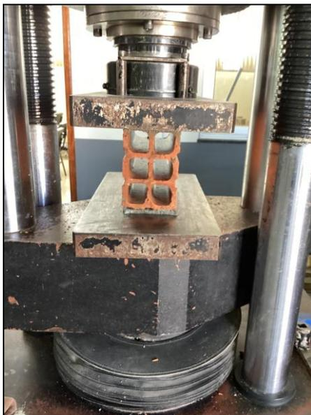
Figura 12 – Bloco cerâmico posicionado na prensa para rompimento
