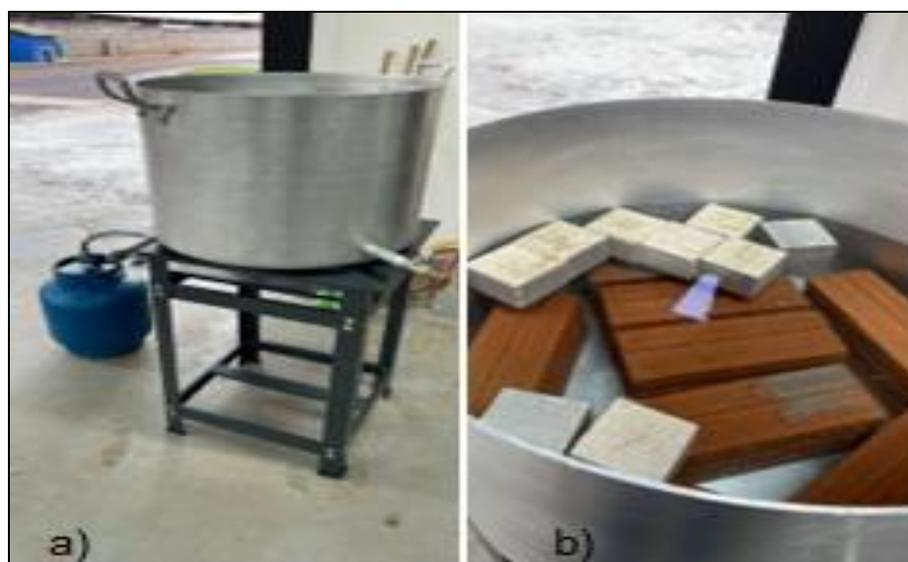
Figura 10 – a) Aparato de aquecimento para realização do ensaio;
