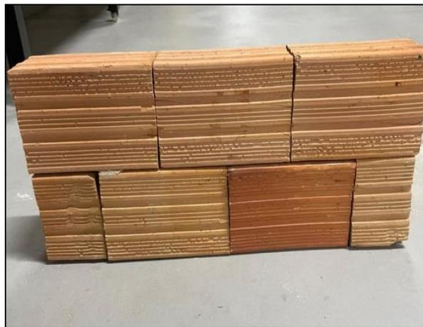
Figura 16– Parede de bloco cerâmico
