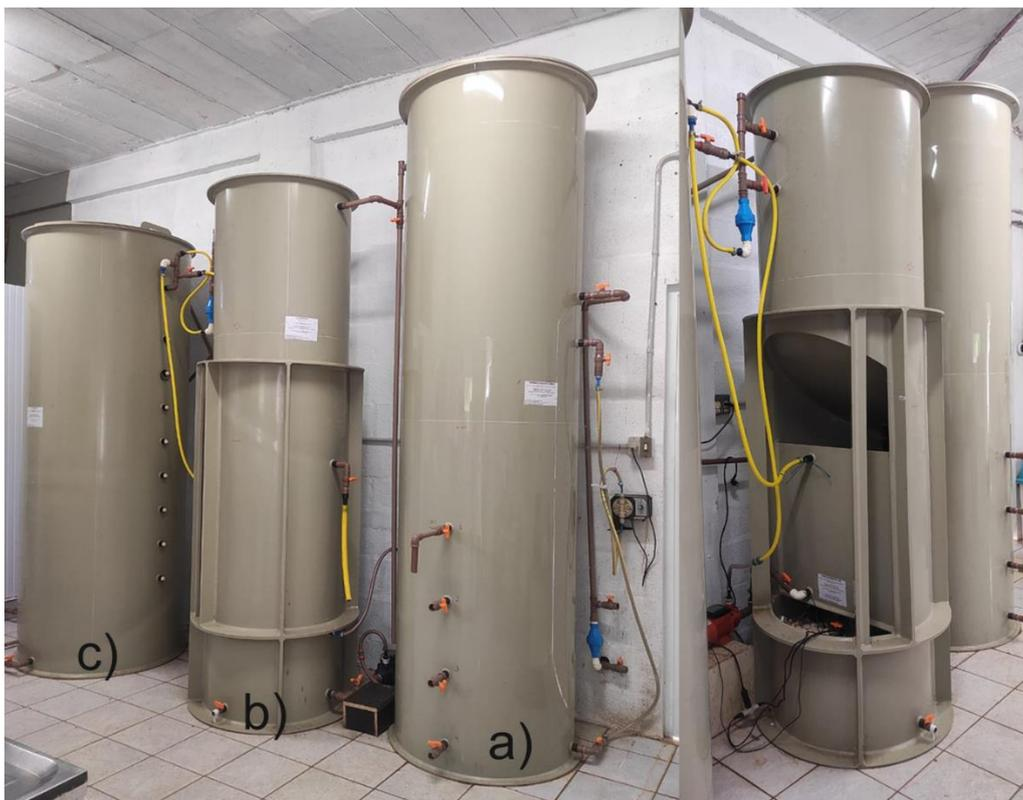
**Figura 5-1** Preparo do efluente para alimentação dos reatores em operação na estação de tratamento, onde: a) Reator UASB; b) Sistema verticalizado (vista frontal do sistema na imagem a direita); c) Tanque pulmão de digestato diluído.
