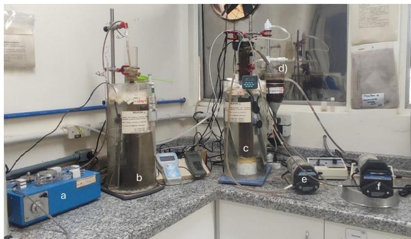
**Figura 6-1** Reatores RA e RD em operação, onde: a) a bomba peristáltica realiza a alimentação do reator RA; b) Reator RA em operação em banho aquecido a 35°C; c) RD operando em banho aquecido a 35°C; d) Decantador do reator RD; e) Bomba de recirculação do reator RD
