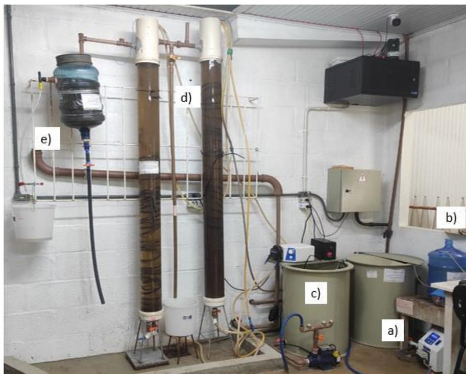
**Figura 5-2** Reator anammox em operação. Onde: a) sistema de alimentação; b) dosagem de nitrito; c) sistema de aquecimento; d) reator de fluxo ascendente e) saída do sistema.
