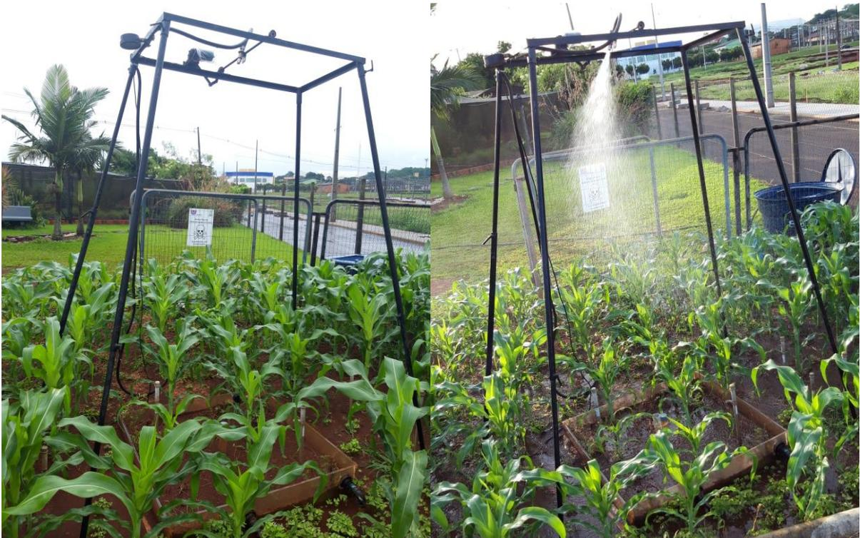
Figura 3.4 - Simulador de chuva instalado sobre a área do lisímetro. À esquerda uma simulação com intensidade elevada ( $150 \text{ mm h}^{-1}$ ).
