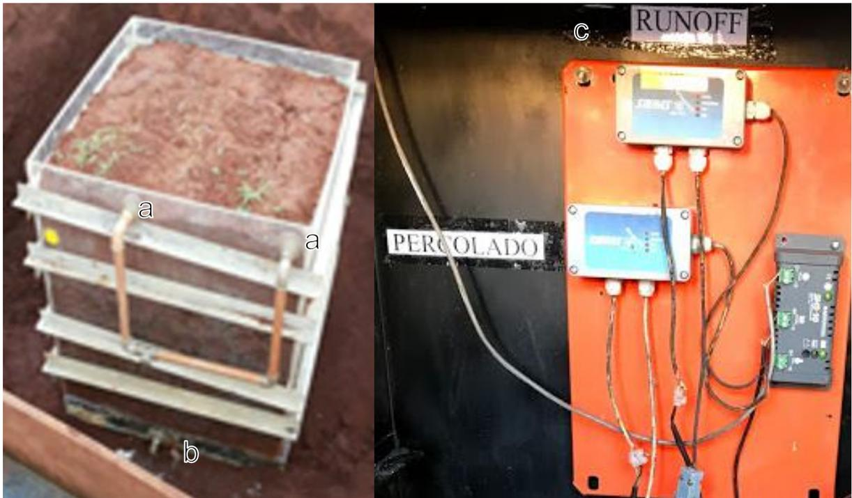
Figura 3.2 - Lisímetro de drenagem instalado no campo experimental da Unioeste, Marechal Cândido Rondon - PR em 2013. a. Orifícios para coleta de escoamento superficial. b. Orifício para coleta de escoamento percolado. c. *Dataloggers* para registro de níveis de escoamento superficial e percolado.
