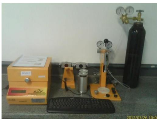
Figura 6 – Bomba calorimétrica
