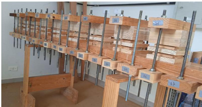
Figura 13 – Aparato de prensagem com as lâminas coladas.
