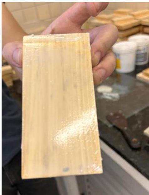
Figura 12 – adesivo espalhado em uma das faces da madeira.
