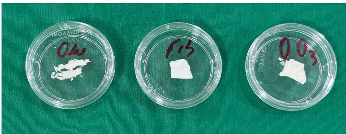
1ª Membrana com óleo de girassol *in natura*, 2ª (ao centro) membrana sem aditivos, 3ª membrana com óleo de girassol ozonizado.
