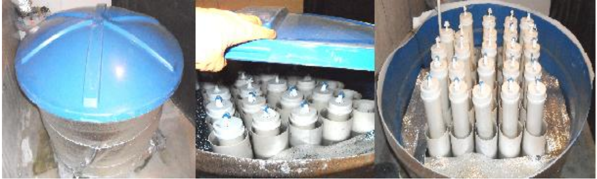
Figura 06. Sistema contendo as unidades biodigestoras. Fonte: Elaborado pelo autor, 2013.
