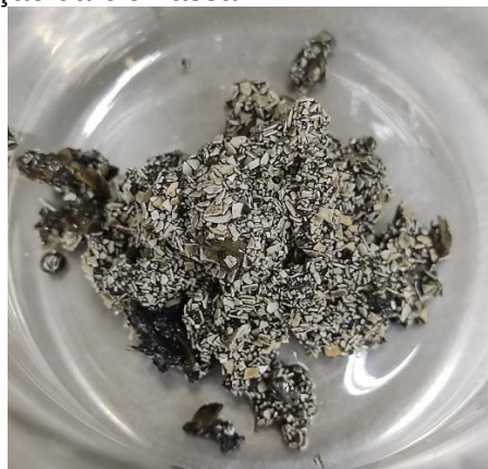
Figura 13 – Cascas de ovos presentes na biomassa coletada pela válvula de descarte do reator e recirculada pela entrada de alimentação anterior ao procedimento de alimentação, para auxiliar a homogeneização da biomassa
