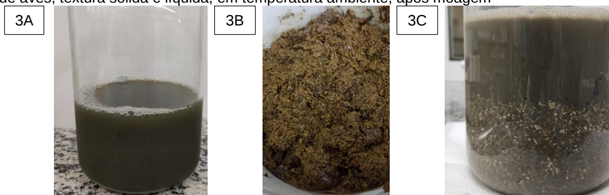
Figura 3 – 3A) Dejetos suíno, textura líquida, em temperatura ambiente, após coleta; 3B) Dejetos bovino, textura pastosa, em temperatura ambiente, após coleta; e 3C) Resíduo de incubatório de aves, textura sólida e líquida, em temperatura ambiente, após moagem
