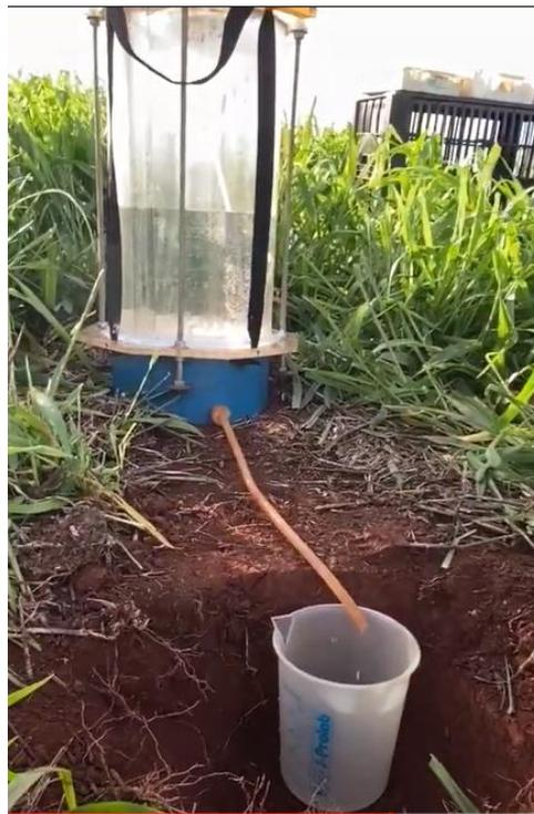
Figura 3 - Determinação do ES e da infiltração com infiltrômetro modelo Cornell. (Imagens do Livro Diagnóstico rápido da estrutura do solo – DRES).
