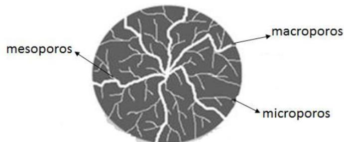
**Figura 3.10 - Estrutura porosa de uma partícula de adsorvente bidisperso (Fonte: Adaptada de Weber & Smith, 1986).**
