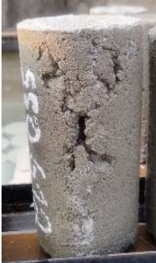
Figura 12. Problema de adensamento em traço S506
