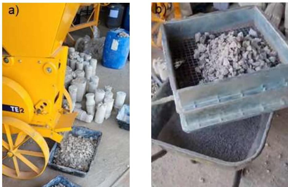
Figura 8. Processo de britagem e peneiramento do resíduo de concreto. (a) vista do processo de trituração. (b) vista da separação entre as frações miúda e graúda.
