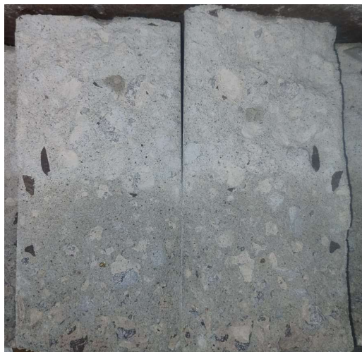
Figura 17. Ruptura em compressão diametral de substituição 100% em traço pobre
