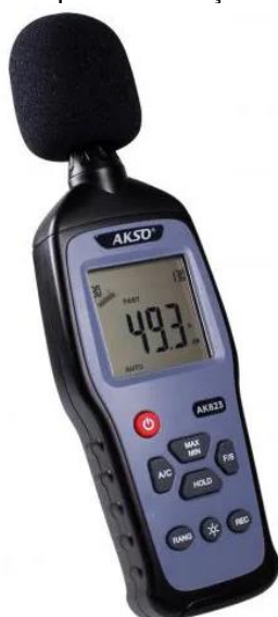
Figura 19– Decibelímetro AK823 utilizado para a medição de níveis de pressão sonora em decibéis.
