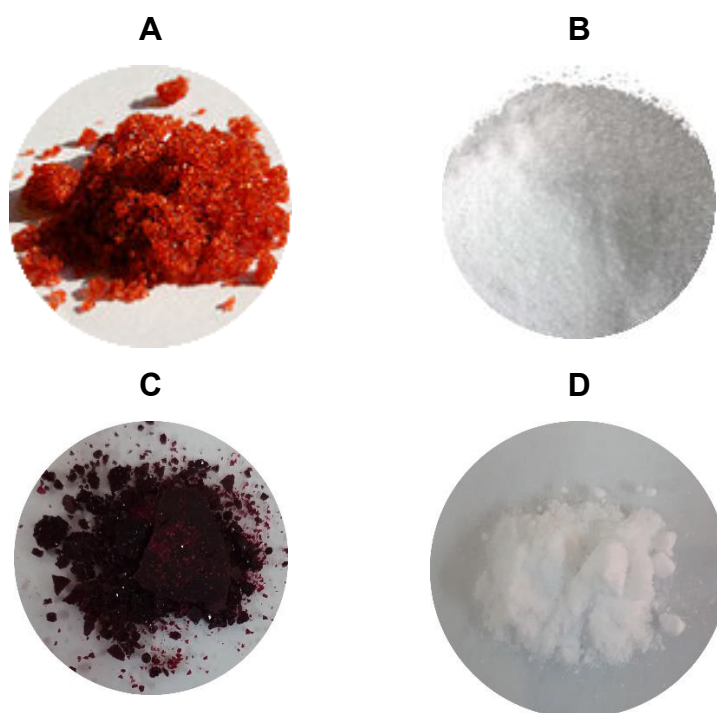
Figura 14 – Precursores das sínteses realizadas; \text{Co}(\text{NO}_3)_2 \cdot 6\text{H}_2\text{O} (A), \text{Zn}(\text{NO}_3)_2 \cdot 6\text{H}_2\text{O} (B), CoMOF (C) e ZnMOF (D). Fonte: O autor.
