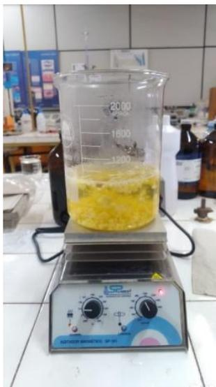
Com uma rede de micra foi retirado o material sobrenadante e descartado o restante do resíduo do bagaço da laranja. Logo após foi adicionado álcool etílico 99% ao material sobrenadante para a precipitação da pectina (Figura 7), após uma hora em repouso através de uma rede de plâncton essa solução foi filtrada e o material filtrado lavado três vezes em álcool 95% e após, o material foi seco em estufa a 55° até seu peso ser constante (Figura 8).
