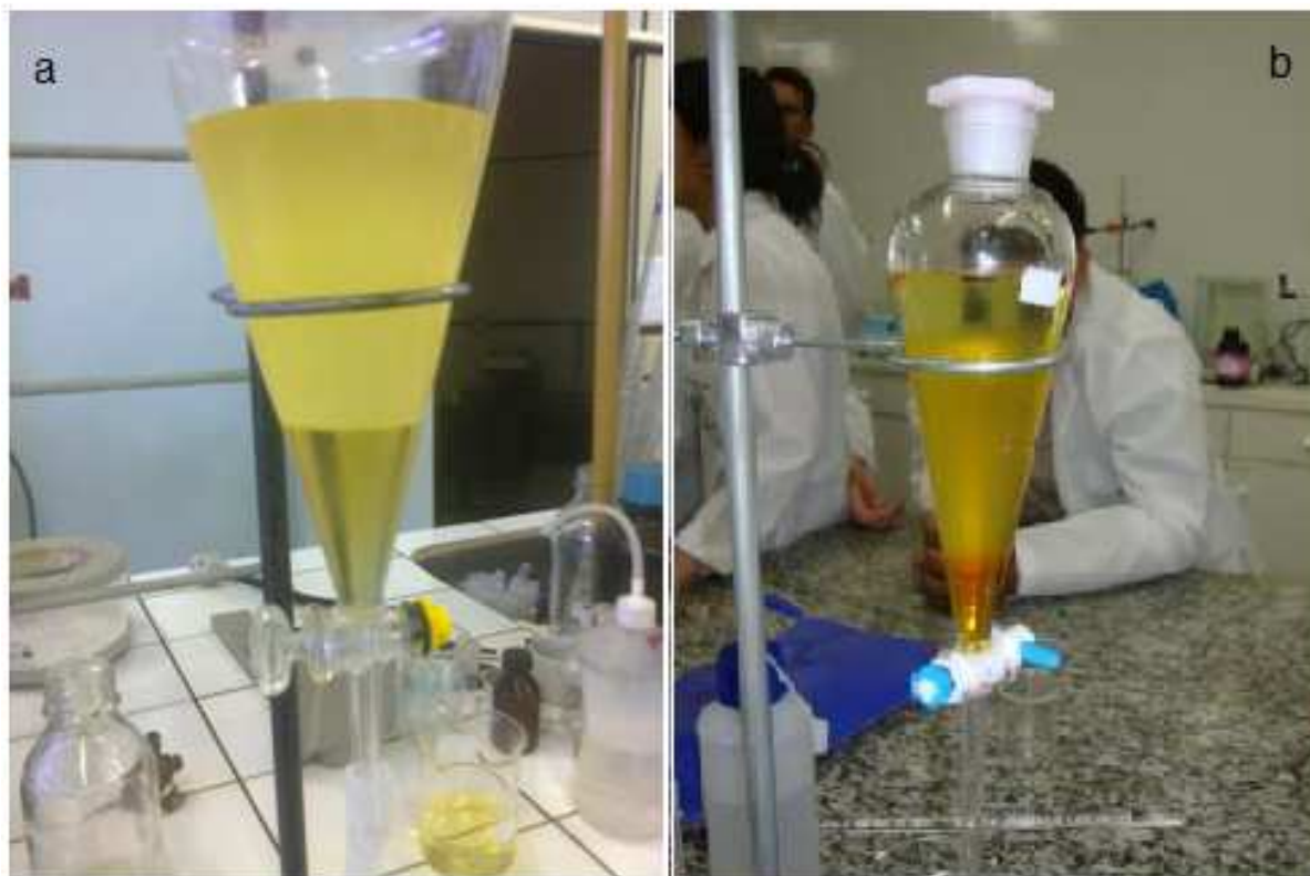
Figura 6. Fotografia da separação de fases: biodiesel de soja (a) e mamona (b)
