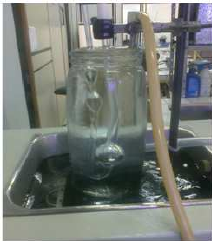
Figura 9. Fotografia do viscosímetro em banho a 20 °C
