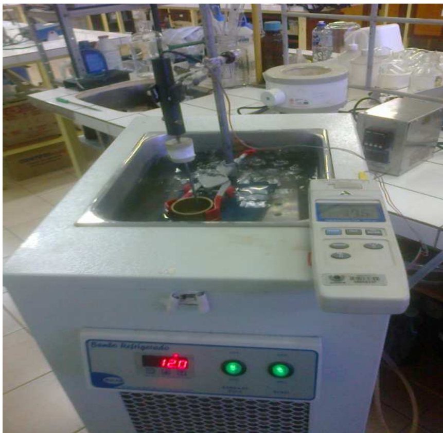
Figura 10. Fotografia do aparelho para determinação do ponto de fulgor
