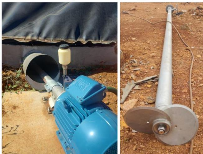
**Figura 13** - Sistema de revolvimento da massa com os agitadores.
