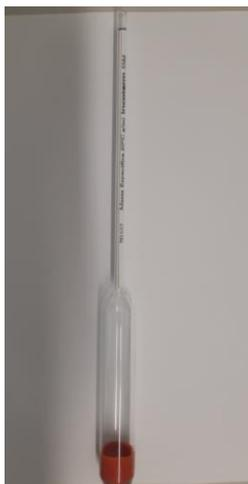
**Figura 18** - Densímetro para massa específica 001 5582.
