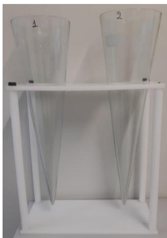
**Figura 19** - Cone Imhoff graduado para análise sólidos sedimentáveis.
