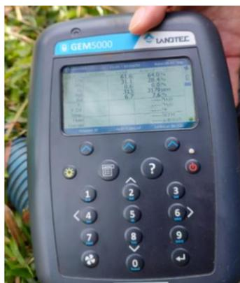
**Figura 21** - Monitor GEM5000 de extração de gases.
