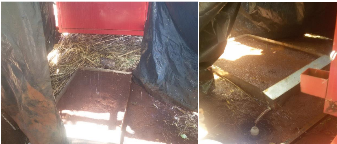
Figura 10 – Chuva simulada na parcela e momento da coleta do material escoado. Fonte: O Autor.
