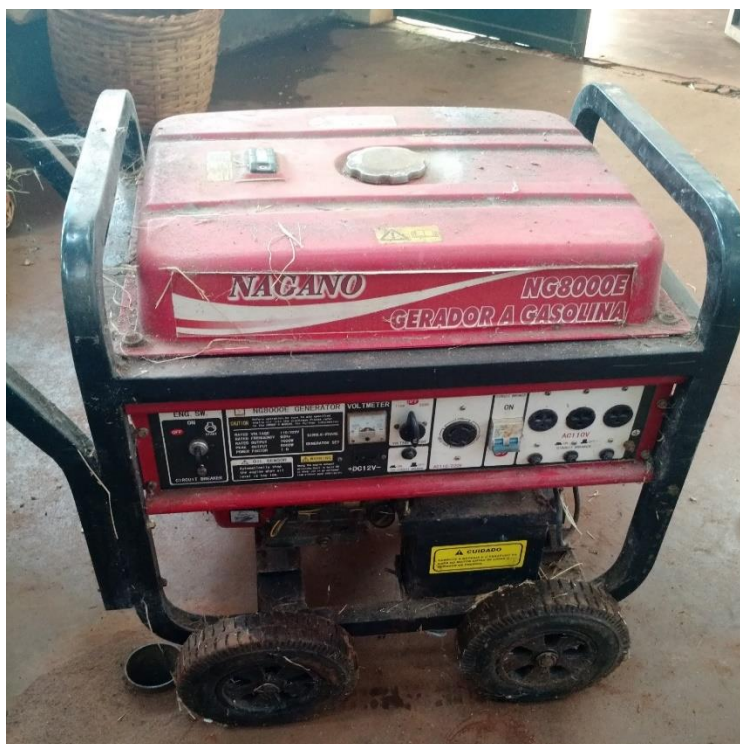
Figura 11 – Gerador a gasolina. Fonte: O Autor.
