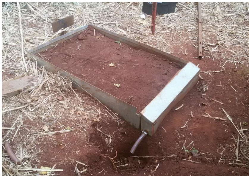
Figura 4 – Parcela e calha coletora instalada.
