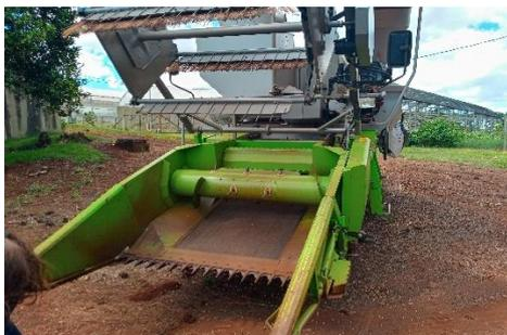
Figura 4 Debulha das espigas de trigo: Colhedora motorizada de marca Wintersteiger.
