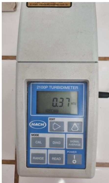
Figura 7: Turbidímetro
