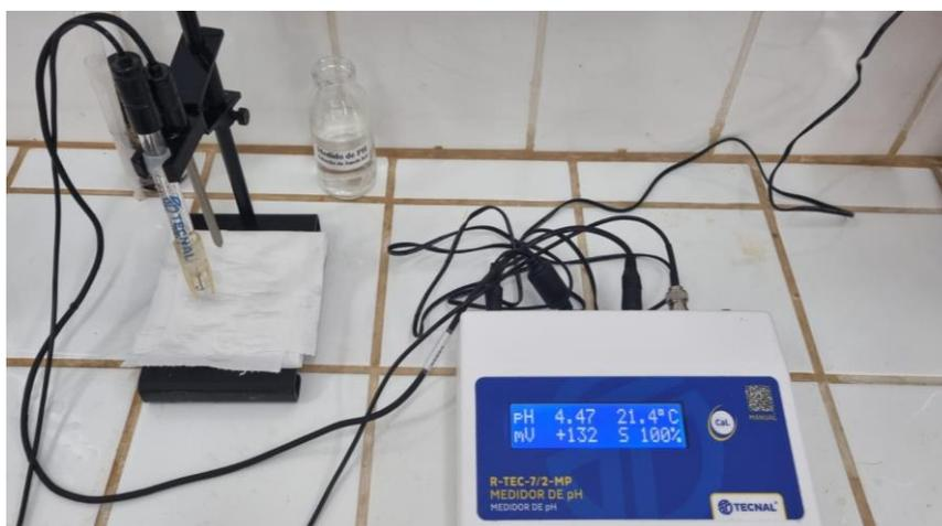
Figura 3: medidor de pH
