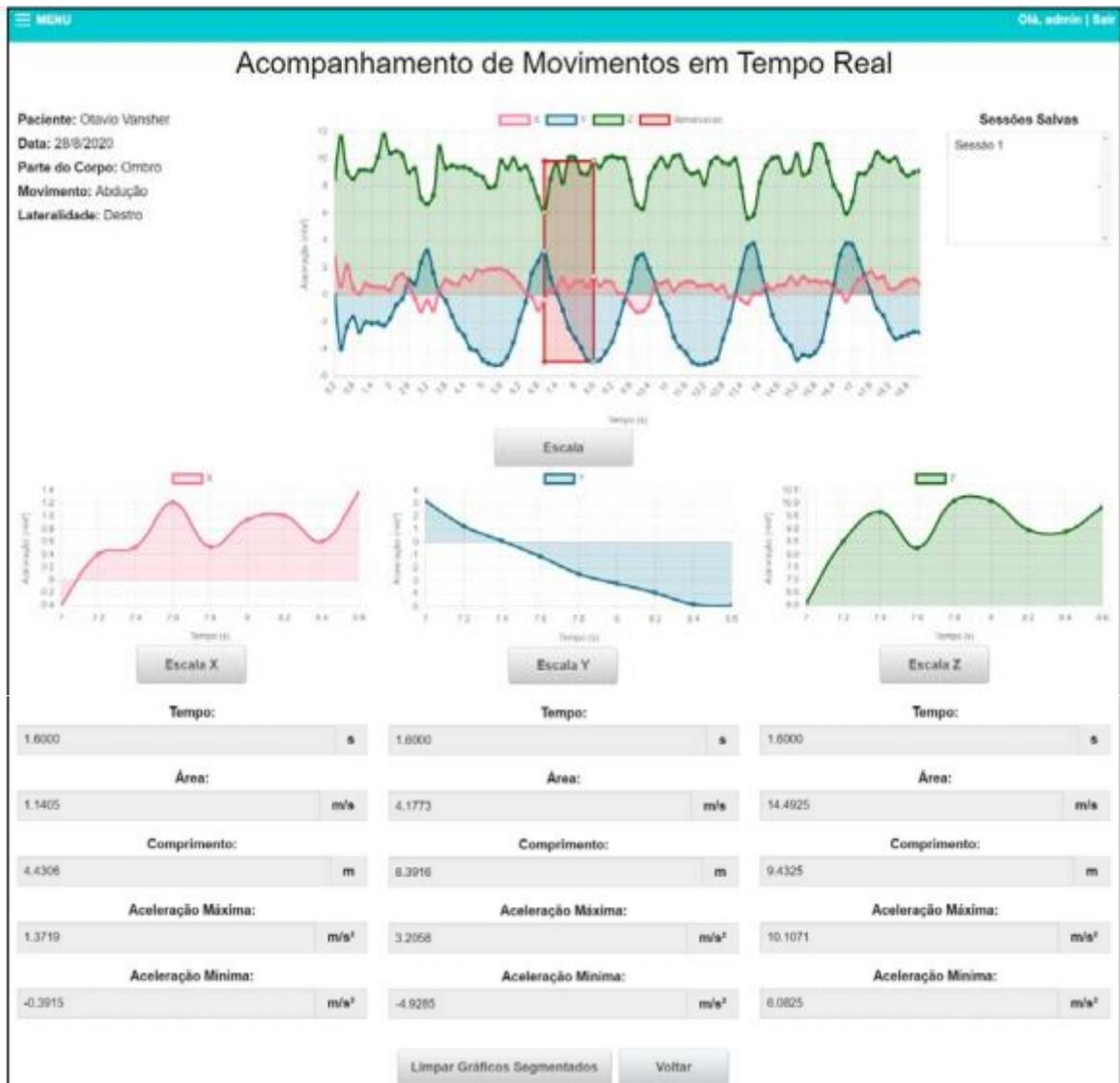
**Figura 14** – Exemplo de leiaute da tela de acompanhamento de movimento em tempo real com acesso via receptor notebook com trecho de demarcação na curva de interesse. Fonte (ENSINA *et al.*, 2020).
