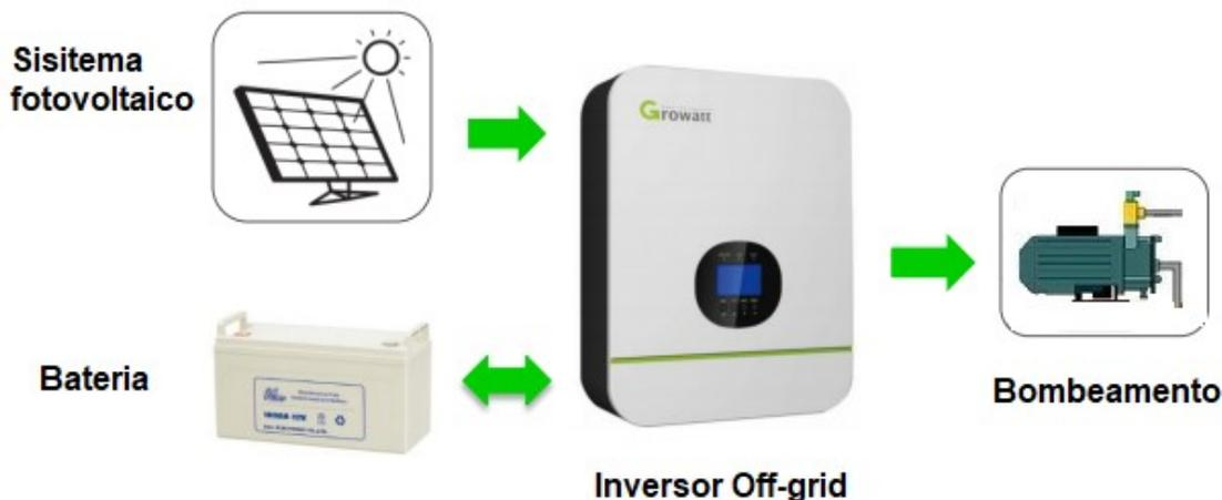
Figura 7 - Configuração do sistema fotovoltaico off-grid.
