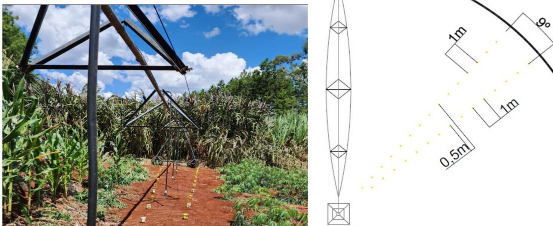
Figura 13 - Imagem realizada durante um dos ensaios de uniformidade na aplicação de água e o layout gráfico das distâncias adotadas no posicionamento dos coletores
