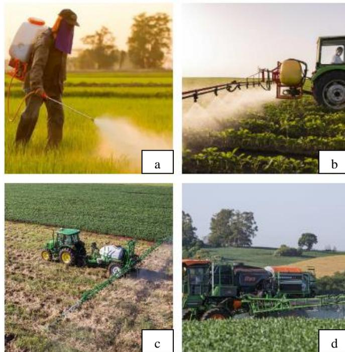
Figura 1: Tipos de pulverizadores terrestres: (a) costal; (b) tratorizado; (c) de arrasto; (d) autopropelido.
