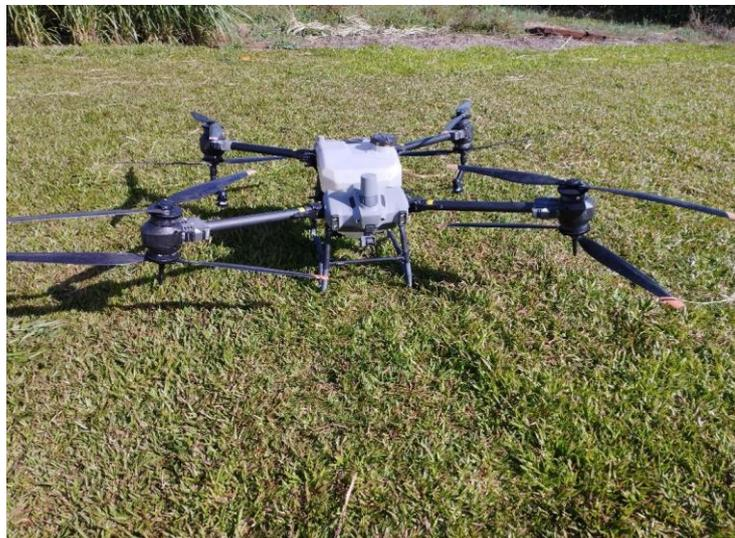
Figura 6: Drone de pulverização DJI modelo Agras T40
