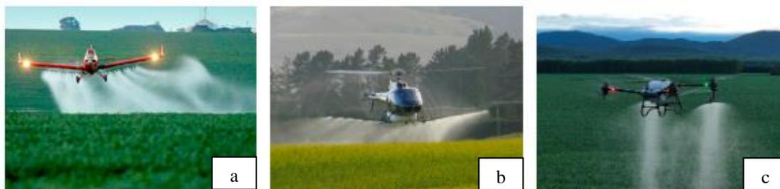
Figura 2: Tipos de pulverizadores aéreos: (a) avião; (b) helicóptero e; (c) Drone.
