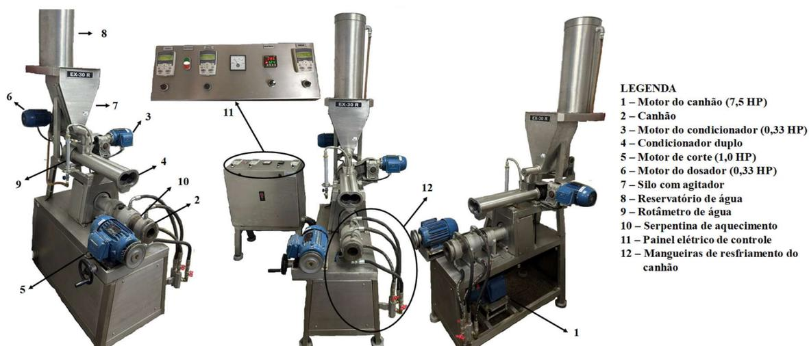
**Figura 1** – Vistas laterais, frontal, painel elétrico de controle e componentes da extrusora Extec® EX-30R.
