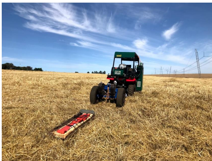
Figura 4 Quadriciclo e condutivímetro, utilizados para coleta de dados de CEa nas áreas experimentais no município de Céu Azul-PR, 2023
