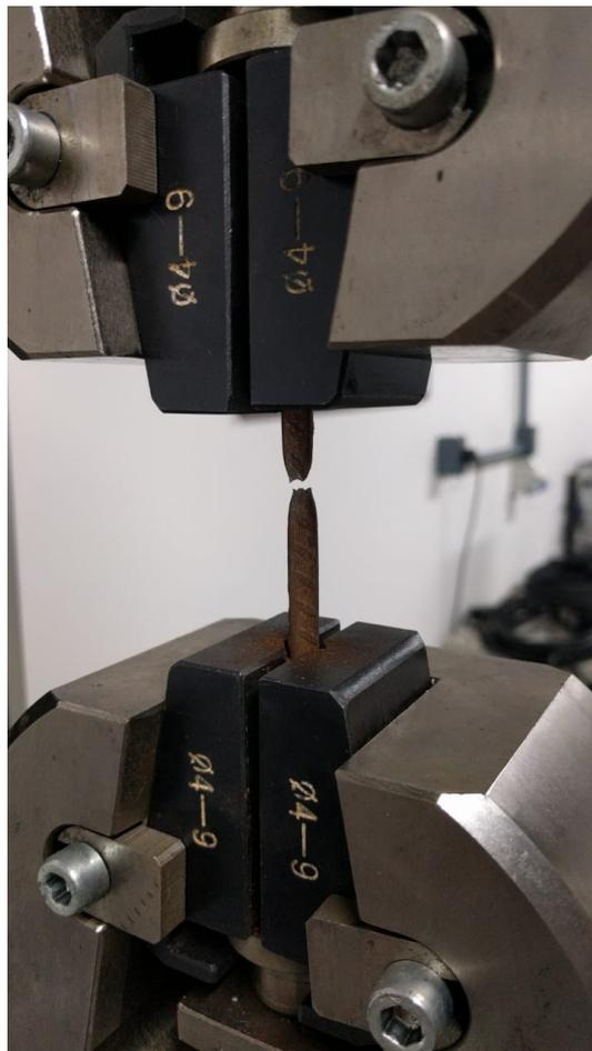
**Figura 9:** Rompimento da amostra de Aço 3,4mm CA-50
