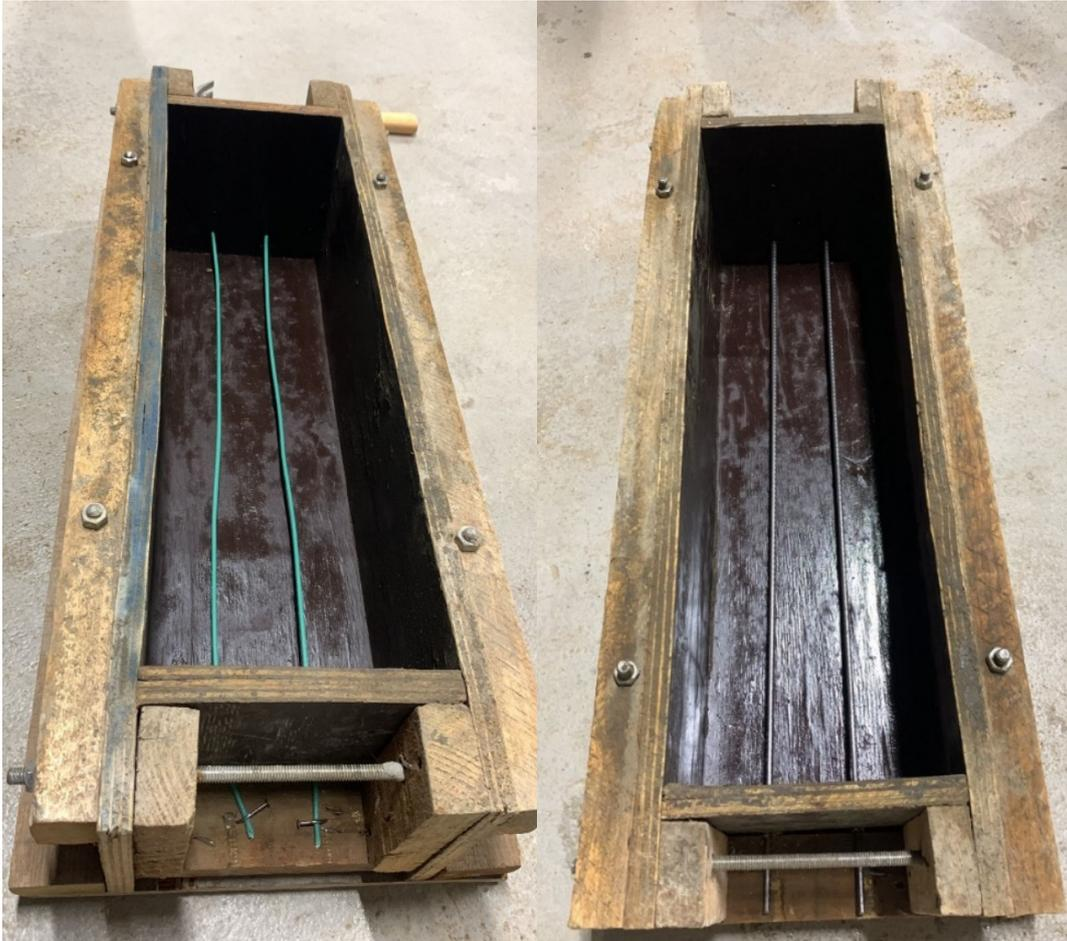
**Figura 5:** Moldes de madeira para concretagem dos corpos prismáticos com altura de capa.
