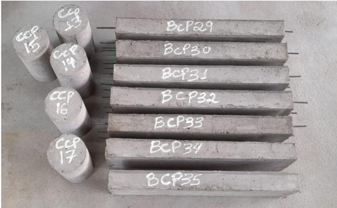
**Figura 4:** Detalhe de um lote padrão dos corpos de prova prismáticos e dos cilíndricos retirados em cada batelada.
