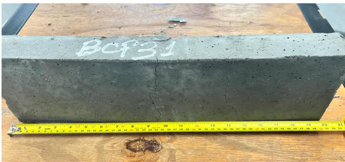
**Figura 13:** Medida da distância de ocorrência do rompimento a partir da lateral do corpo de prova
