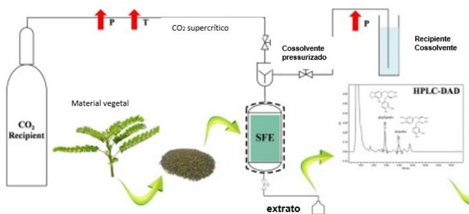
Figura 3 Representação esquemática do processo de extração com fluido supercrítico. Fonte: Adaptado de Pereira et al. (2017).
