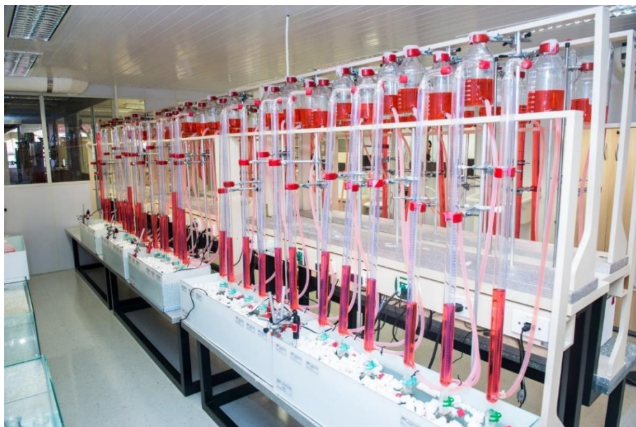
Figura 14: Eudiômetro utilizado para medir o volume dos gases Fonte: CIBiogás (2023)
