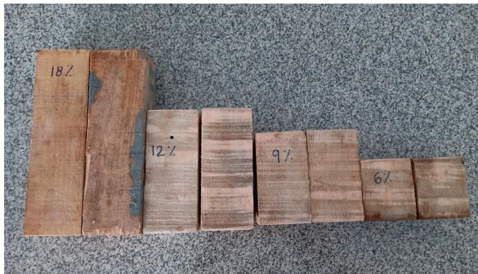
Figura 3. Blocos de madeira para instalação das declividades.
