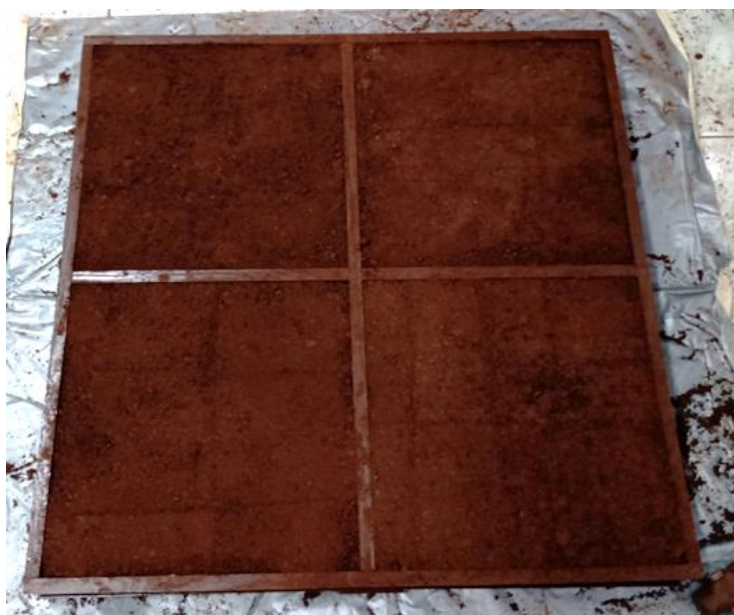
Figura 6. Gradil de madeira com quadrantes preenchidos com solo na densidade desejada.
