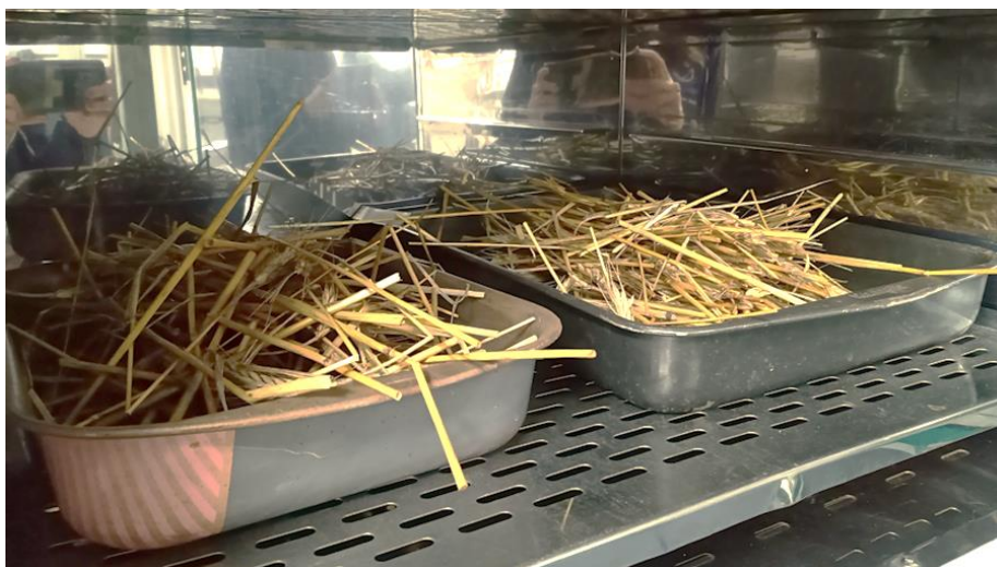
Figura 9. Determinação da umidade da palhada em estufa com circulação forçada
