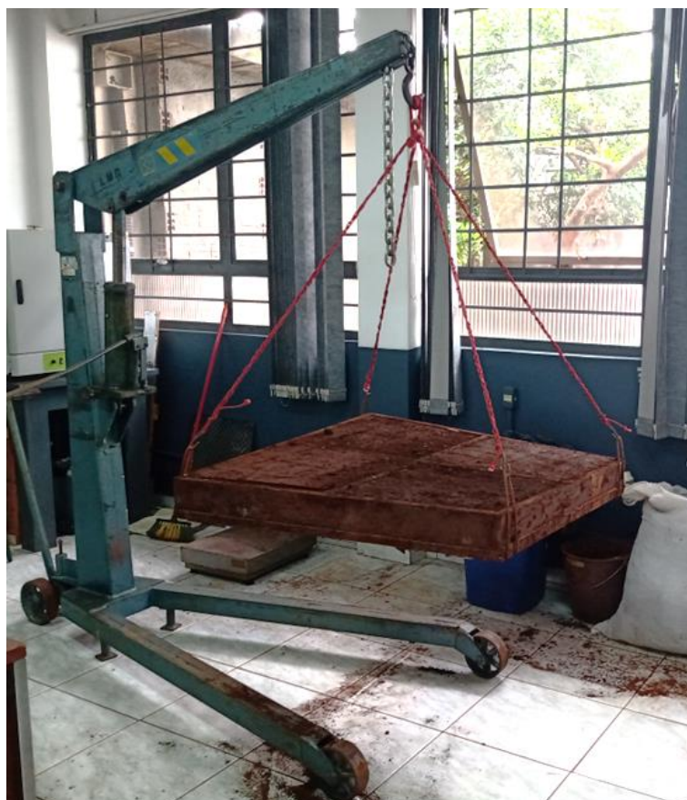
Figura 7. Transporte do gradil de madeira com auxílio do guincho.
