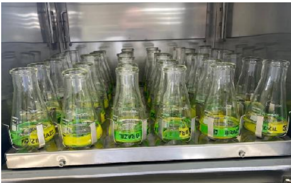
Figura 4 - Processo de agitação das pulseiras para limpeza (agitador orbital 120 rpm).
