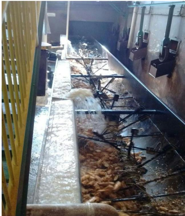
Figura 1 Calha de lavagem das raízes.
