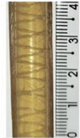
Figura 5 Parede interna do tubo com ranhuras (medidas em cm, sem escala).
