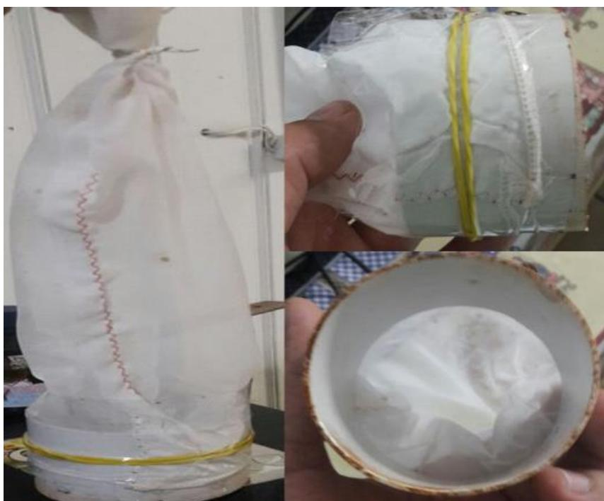
Figura 1. Gaiola utilizada para manter os percevejos nas plantas de milho, sustentada por armação de plástico tipo PVC com o teto e as laterais revestidas por tecido telado tipo voil.
