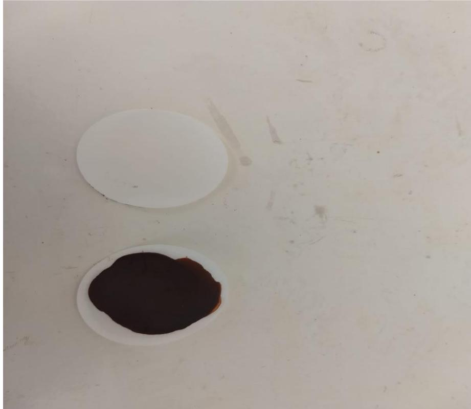
**Figura 3.3** - Membranas de 0,45  $\mu\text{m}$  utilizadas na filtração das amostras, antes e após filtração.
